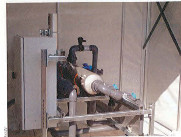
Des échantillons d'eau ont été pris en entrée et en sortie de filtre à sable et de réacteur UV.
